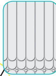
PLAQUES SÈCHES DE PLÂTRE ARMÉE DE FIBRES DE CELLULOSE - collées ou vissées entre elles
